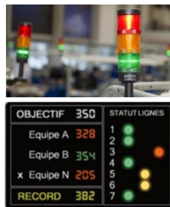
Figure 1-3 : Exemple d'Andon – Systèmes d'alerte reliés aux équipements de production – D'après l'INRS
