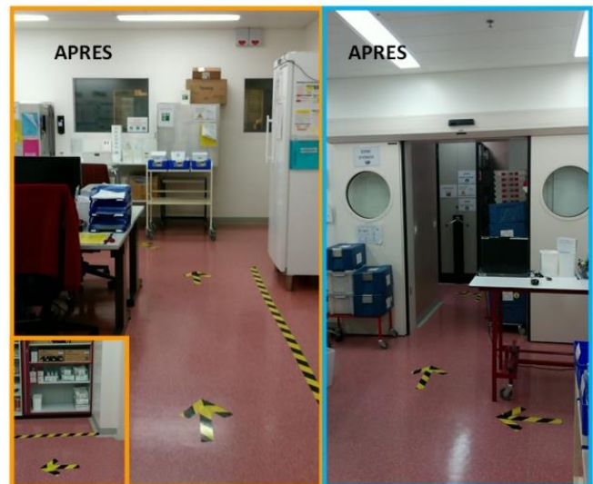
Le parcours d'un produit est intégralement fléché, facilitant la compréhension d'un visiteur ou d'un nouvel opérateur.
