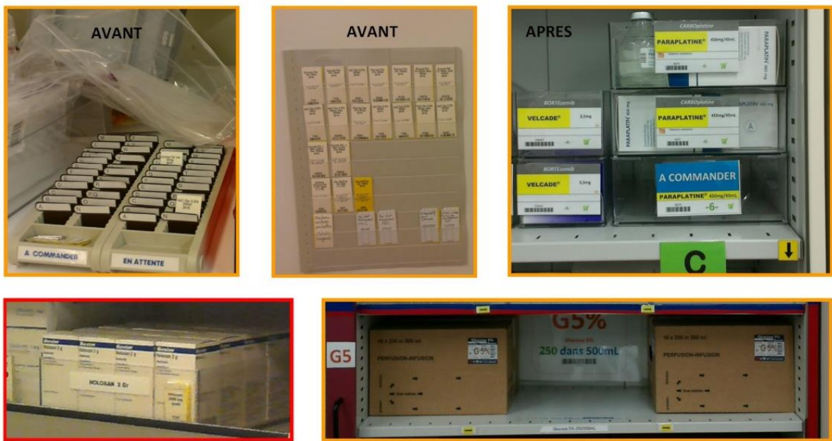
Le stock géré à l'œil et nécessitant de déplacer des étiquettes bascule sur une gestion de type plein-vide et visuelle.
